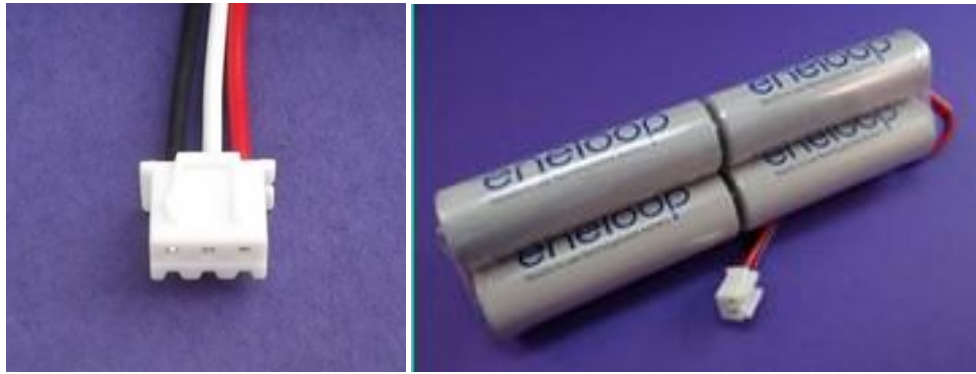
Prinzip des Umbaus: Von der Ladebuchse direkt auf die Pins des Akkusteckers
