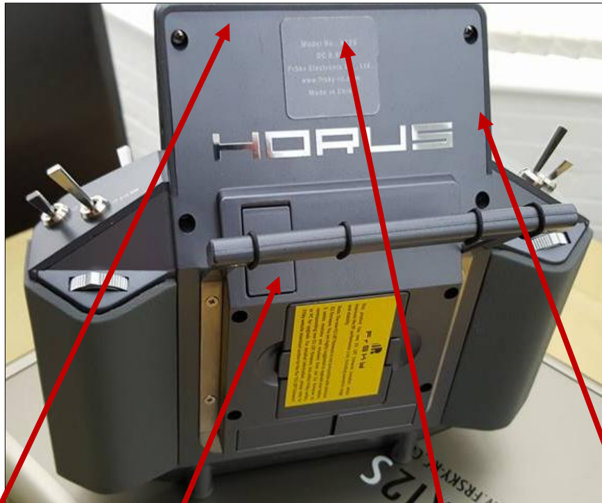
Interne Streifenantenne Anschluss für 2.Antenne GPS-Modul Bluetoothantenne
