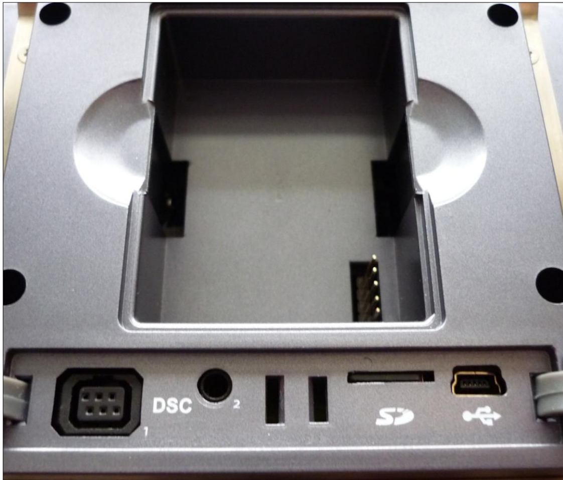
2 DSC-Buchsen (Futaba und Klinke) JR Modulschacht und Anschlüsse SD-Karte und Mini-USB
