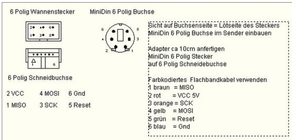
Belegung von Stecker, Kabel und Farben
