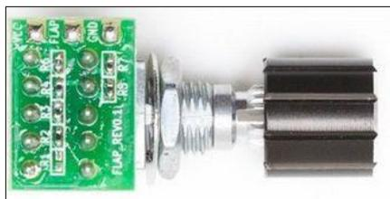
**Wenn ein Stufenschalter eingebaut wurde, muss er auch abgeglichen werden, siehe (8/8), da er ja ein Poti ersetzt!**
