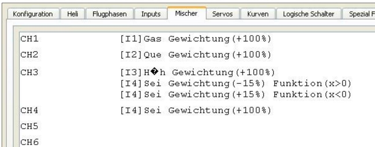
Hier wird das Seitenrudersignal in den Inputs nur durchgereicht, keine extra Vorverarbeitung. Die Anpassung erfolgt direkt im Mischer CH3 Höhenruder mit 2 zusätzlichen Zeilen. Wenn der Wert positiv ist ( $x>0$ ) wird die Mischerzeile mit -15% aktiv. (plus \* minus = minus) Wenn der Wert negativ ist ( $x<0$ ) wird die Mischerzeile mit +15% aktiv (minus \* plus = minus)
